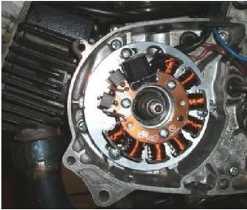
Setzen Sie jetzt die neue Statoreinheit auf den Motorblock (die Kabeldurchführung der Grundplatte zeigt dabei in Richtung des Kabelausganges des Motorgehäuses) und befestigen diese mit den 3 mitgelieferten Schrauben M5. Benutzen Sie keine anderen Schrauben, deren Köpfe könnten zu hoch sein!
