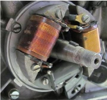
Entfernen Sie die Paßfeder von der Kurbelwelle, die in die Nut des alten Limarotors ging. Keine Angst, die hat keine Haltefunktion, sie sollte nur zur ZündEinstellung führen. Vergessen Sie die Paßfeder zu ziehen, geht später der Rotor nicht auf die Welle und Sie müssen den Stator erneut abbauen um an die Paßfeder zu kommen.
