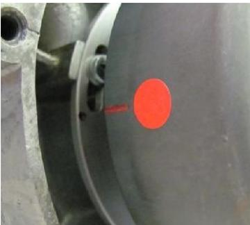
Entfernen Sie die Zündkerze und bringen Sie den Kolben in Zündzeitpunktstellung. Sie können dazu den neuen Rotor locker auf die Welle stecken und diese damit drehen.
