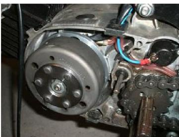
In dieser Position befestigen Sie den Rotor wieder mit der originalen Rotormutter.
