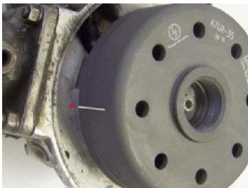
Ziehen Sie den Rotor wieder von der Kurbelwelle ab (dazu eignet sich unser Abzieher) und stecken ihn nun wieder so auf die Kurbelwelle, dass die Markierung auf dem Umfang genau an der Zündmarkierung der Grundplatte steht. Drücken Sie den Rotor fest auf die Welle.
