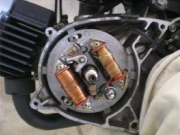
Lösen Sie die Befestigungsmutter des Rotors und ziehen Sie diesen von der Kurbelwelle ab. Dazu benötigen Sie den geeigneten Abzieher.
