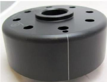
Sehen Sie sich jetzt den neuen Rotor an. Auf seinem Umfang finden Sie eine kleine eingepresste Strichmarkierung. Das ist ebenfalls eine Zündeneinstellmarke. Diese ist durch die Einpressung dauerhaft aber eingebaut nicht immer gut zu sehen. Ein Nachziehen mit Faserstift ist daher eine gute Idee.
