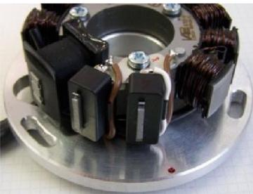
Schauen Sie sich die neue Statoreinheit an. Auf der Grundplatte, nahe den schwarzen Spulen, werden Sie die rote Zündmarkierung finden.
