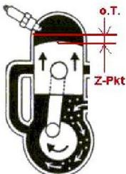
Zum Messen der Kolbenposition benötigen Sie ein Werkzeug (eine [Meßuhr](#) oder einen Meßstab, den man z.B. aus einer alten Zündkerze anfertigen kann ([Info hier](#))). Zur großen Not geht aber auch ein Bleistift und etwas Augenmaß).
